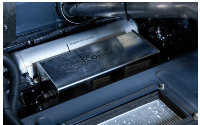
CO 2 -afvanginstallatie geïnstalleerd in het demonstratievoertuig
